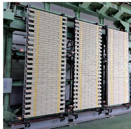
⑤動的変形性能試験の様子
